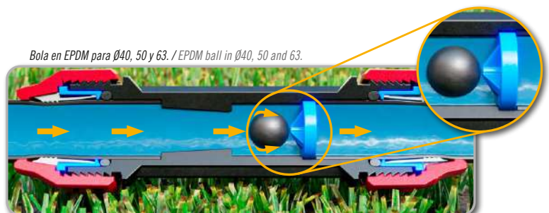
Bola en EPDM para Ø40, 50 y 63. / EPDM ball in Ø40, 50 and 63. El gráfico muestra la sección de un manguito fitting antirretorno con caudal en paso. The chart shows the section of a check fitting coupling with flow passing.
